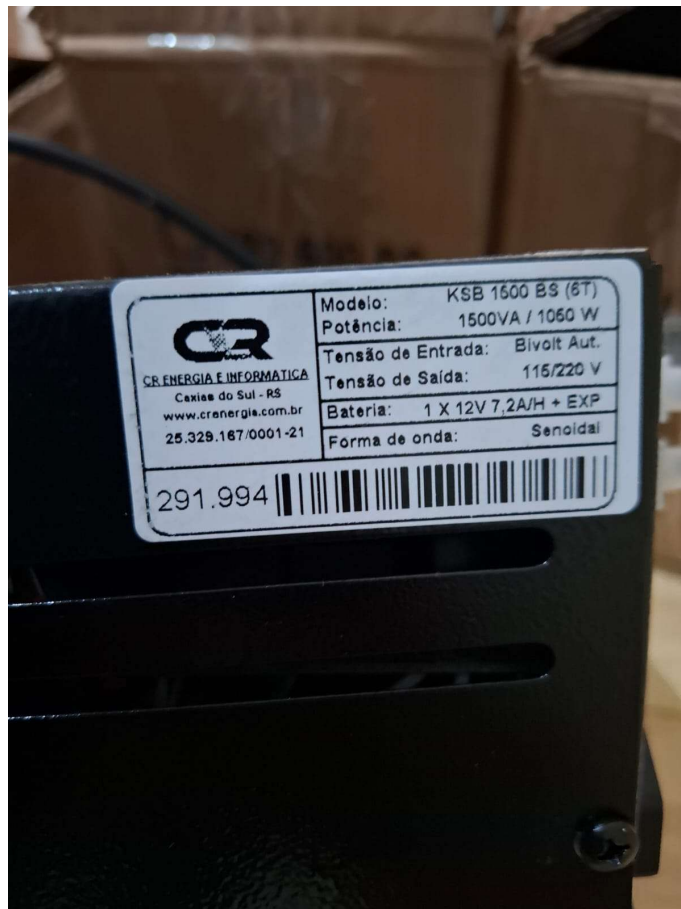
Foto 2: Rótulo do NOBREAK
