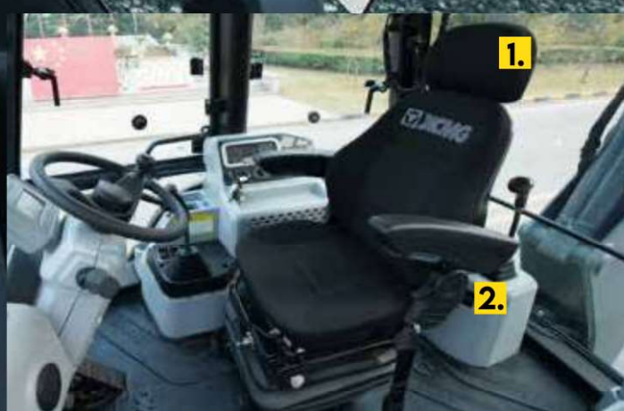
1. Banco do operador ergonômico com apoio de braço, suspensão mecânica regulável, com giro de 180°. 2. Cinto de segurança retrátil.
