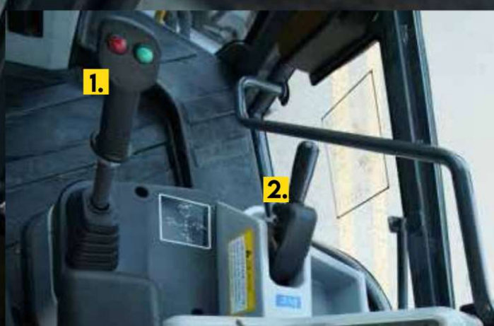
1. Caçamba com nivelamento automático durante o processo de levantamento do braço, com variação de até 1,5° na caçamba. 2. Freio de estacionamento de acionamento mecânico de simples estágio.
