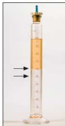
Desenho 2 50 ml de gasolina + 50 ml de solução aquosa NaCl a 10%. Gasolina sem etanol. 13 ml de aumento da camada aquosa.
