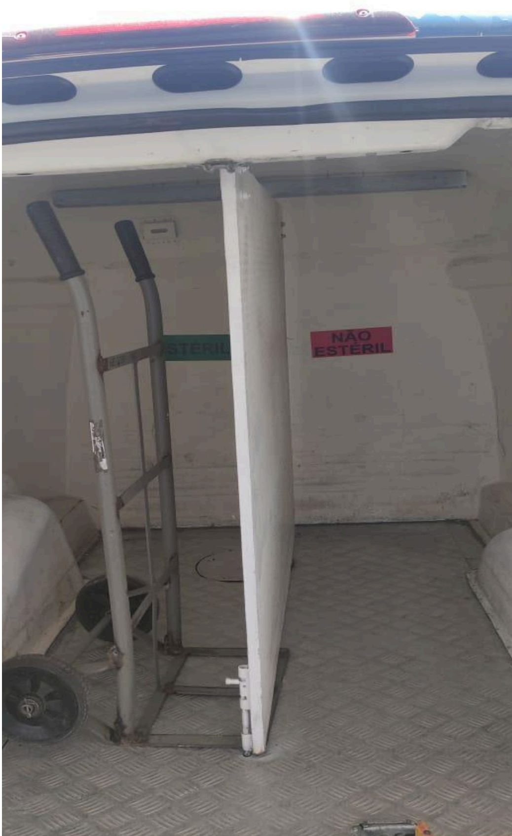
Foto x: Interior do veículo de transporte de material estéril e não estéril de pequenos volumes, em que há separação dos materiais através de barreira física.
