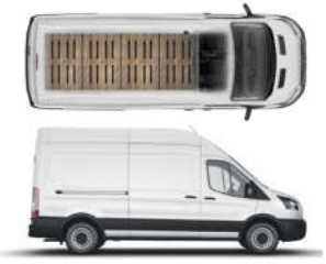
L3H3 Furgão com capacidade volumétrica de carga de 12,4m³ e categoria "B" de habilitação,
